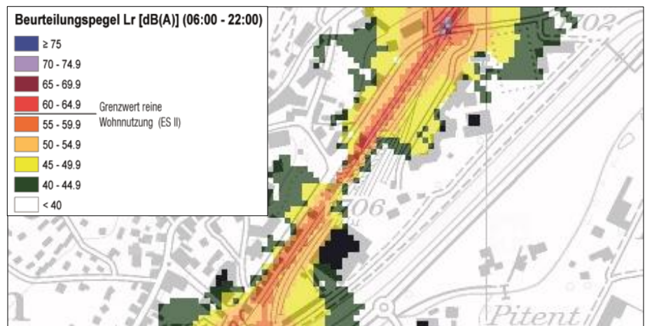
Ausschnitt GIS-Lärmdatenbank sonBASE, Eisenbahnlärm Tag (BAFU, nicht massstäblich)
