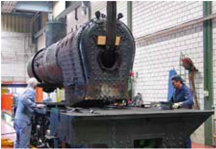
Der alte Kessel wird ausgebaut
