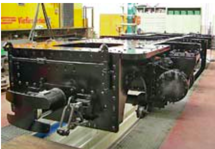
Der umgebaute und frisch revidierte Rahmen in Landquart
