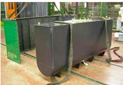
Der Öltank wurde im Kohlenkasten eingepasst
