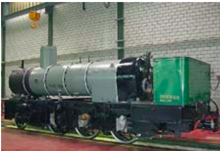
Der neue ölgefeuerte Kessel ist eingebaut
