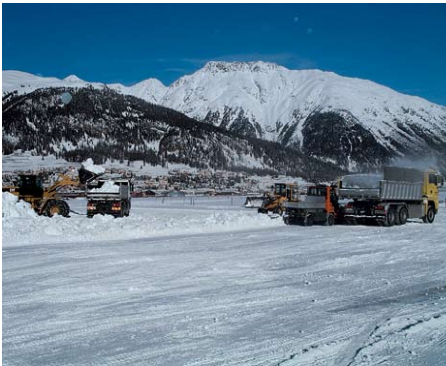
Der an einen Haufen geschneite Schnee muss zuerst gelockert werden, bevor er mit Fräsen oder Pneuclader auf die LKW verladen werden kann.
