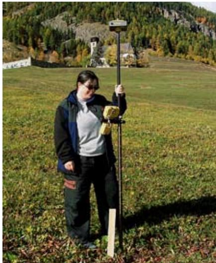
alten Polygonpunkte hervorgesucht und bei Bedarf neue Punkte versetzt und gemessen werden.
